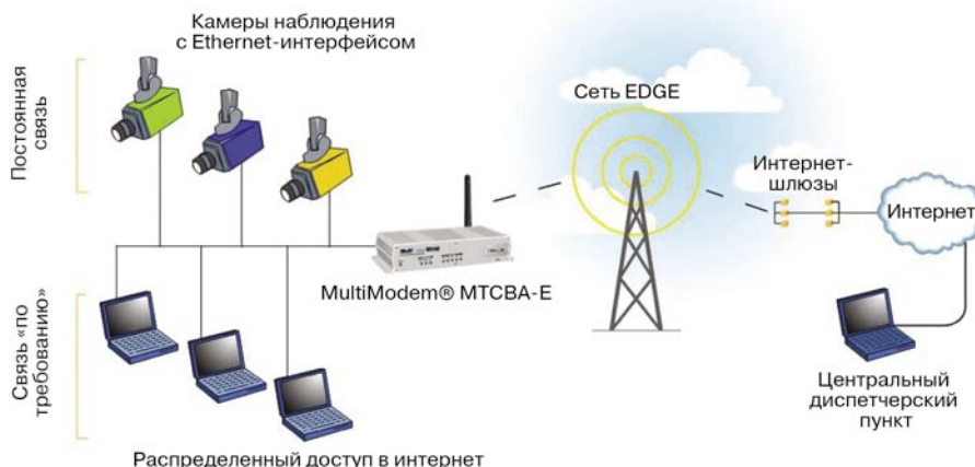
Рис. 5. Пример использования MultiModem® МТСВА с Ethernet-интерфейсом для организации канала связи между удаленной локальной сетью и центральным пунктом управления
