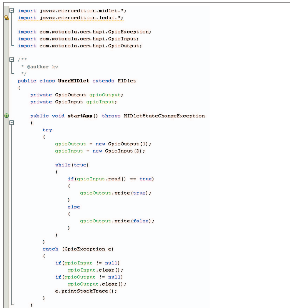
Рис. 4. Пример кода для работы с линиями ввода/вывода модема G24-J
