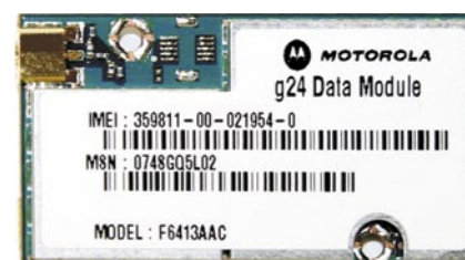
Рис. 1. Внешний вид EDGE-модуля Motorola g24
